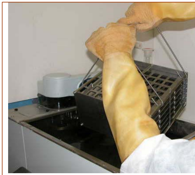
Fig. 13: la rastrelliera contenente 6 griglie, ciascuna delle quali può supportare 49 lastre
